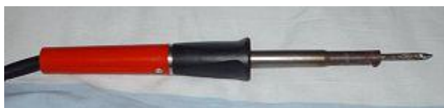
Gewone elektrische soldeerbout met hol element
