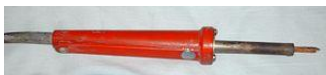
Een soldeerbout met een ingebrande koperen punt
