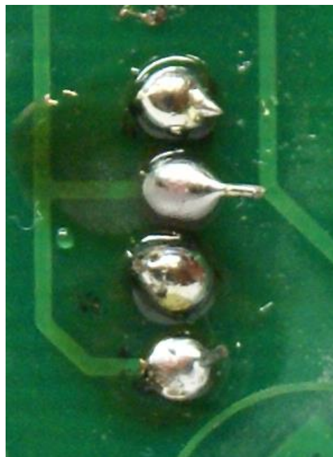
Te veel tin. Er staan "bolletjes" op de soldeereilandjes.
